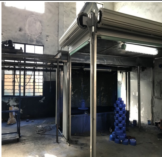
图 3-2 喷台水幕喷淋装置
